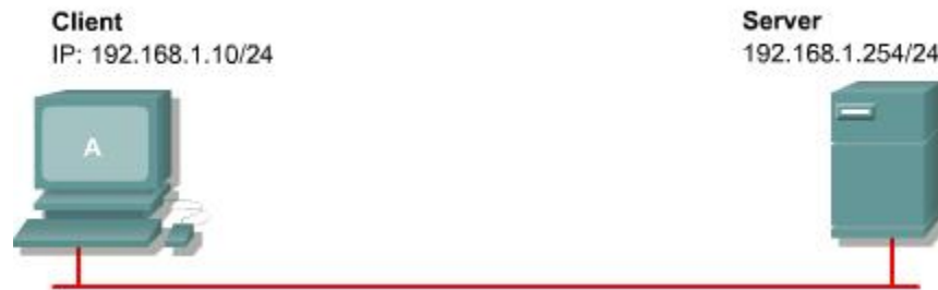
Hình 1.2.1.c. Hệ điều hành trên DHCP client sẽ dùng những thông tin nhận được trong gói trả lời server để cấu hình IP cho client đó.
